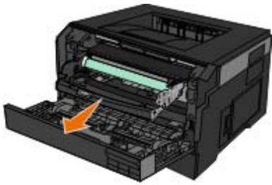
**⚠ 当心：** 打印机内部可能很烫。为避免被发热组件烫伤的危险，在接触组件之前，请等待表面冷却。
